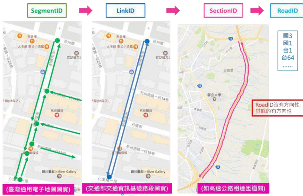
圖 3 Segment-Link-Section-Road 資料代表涵義示意圖(摘錄自交通部即時路況資料標準 V2.0)
